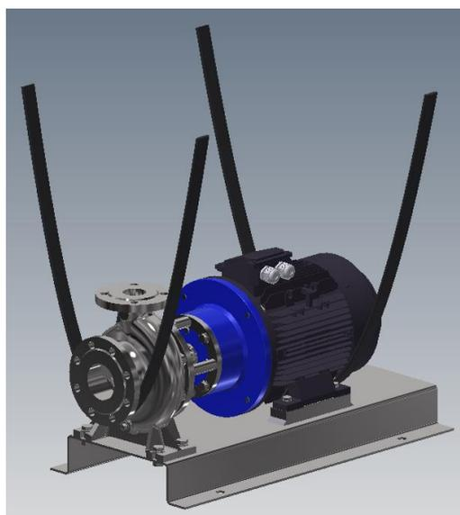
*Fig. 6: Colocación de las cinchas en la bomba monoblock con bancada*
