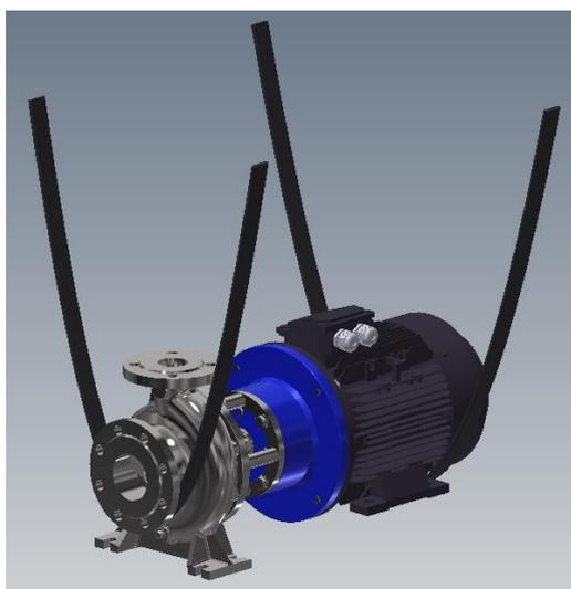
*Fig. 5: Colocación de las cinchas en la bomba monoblock sin bancada*
